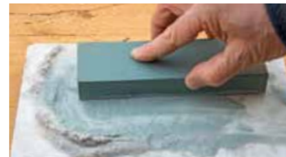
Der Schleifstein wird sanft kreisend auf dem improvisierten Abrichtstein plan geschliffen.
